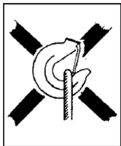
Zawiesie przenosi obciążenie na końcówkę haka!
