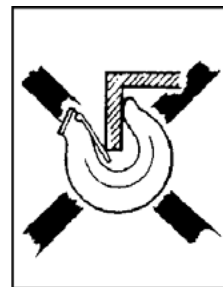
Koncówka haka narażona na dodatkowe naprężenie zginające!
