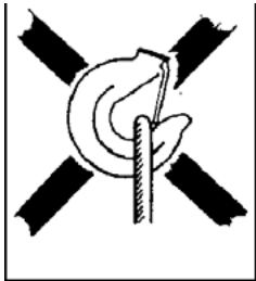
Obr. 2a Řemen přenáší zátěž na konec háku!
